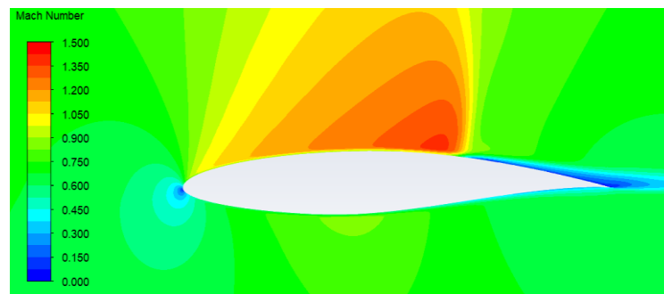
(d) Mach number distribution for a 15% upper camber increase
